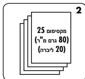
2. נקבו את הגליונות בקבוצות קטנות, כדי לא להעמיס מדי את המכשיר או את המשתמש. התאימו את מדריך הקצה, במקרה הצורך.
