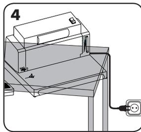
4 Enchufe la máquina a una toma de red de fácil acceso. Conecte el suministro de red.
