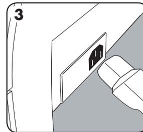
3 Enchufe el cable de suministro eléctrico a la toma de electricidad que hay en la parte trasera de la máquina.
