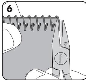
6 Utilice los alicates de corte para cortar y doblar el extremo de la espiral. Corte la espiral que sobre.
