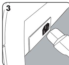
3 Ligue o cabo de alimentação fornecido à tomada na parte de trás da máquina.
