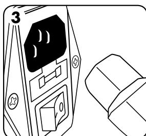
Enchufe el cable de suministro eléctrico a la toma de electricidad que hay en la parte trasera de la máquina.
