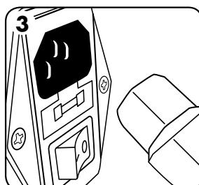
Ligue o cabo de alimentação fornecido à tomada na parte de trás da máquina.
