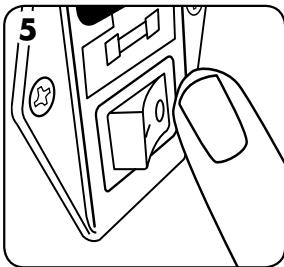
Encienda la máquina usando el interruptor eléctrico que se encuentra en la parte trasera.
