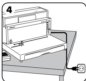
Enchufe la máquina a una toma de red de fácil acceso. Conecte el suministro de red.
