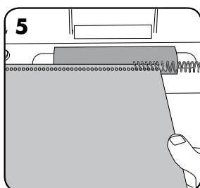
Sujete el documento con las dos manos, y con el espiral metálico en el lateral derecho. Para empezar con la encuadernación del documento, empuje el espiral hacia el rodillo.
