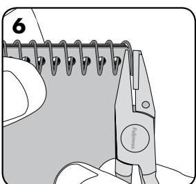
Utilice los alicates de corte para cortar y doblar el extremo del espiral. Corte lo que sobre.
