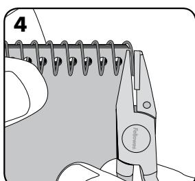
Utilice los alicates de corte para cortar el extremo del espiral.
