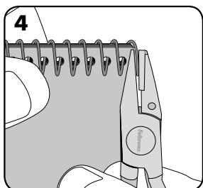
Utilize o alicate para cortar e dobrar a extremidade da espiral metálica. Corte o excedente da espiral.
