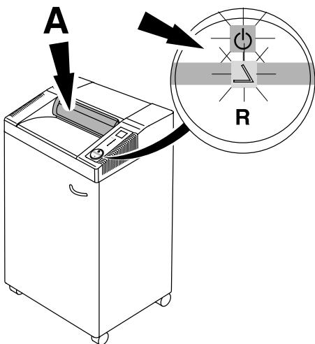
**NL** Automatische stop als de veiligheidsklep (A) geopend wordt (Symbolen  $\triangle$  en  $\odot$  knipperen afwisselend.)
