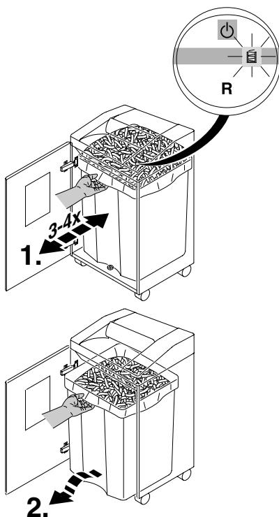
**RUS** При заполнении пластикового мешка аппарат остановится автоматически. Должен загореться индикатор «мешок заполнен». Замените пластиковый мешок. (смотри стр. 8).
