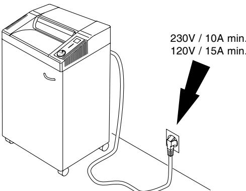
**D** Freier Zugang zum Netzanschluß
