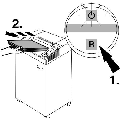
**D Bei Bedarf:** Schalter "R" drücken, Papier entnehmen. (Maschine läuft nur kurz rückwärts, bei Bedarf mehrmals wiederholen).
