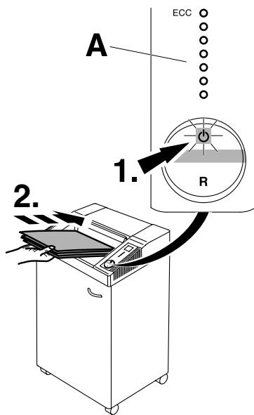
**E** Presionar botón (1.) a luz verde indica que está listo para funcionar. Inicio automático con el indicador en verde en caso de inserción de papel. Modo de espera automático que se apaga tras una hora. El indicador LED verde se apaga .
