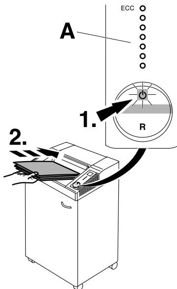
**RUS** Нажмите переключатель : загорится зеленый светодиод, машина снова готова к работе. Машина автоматически начнет работать, если поместить бумагу в приемный слот. Если переключатель выключен в течение часа, машина автоматически переходит в «спящий режим». Зеленый светодиод не горит.
