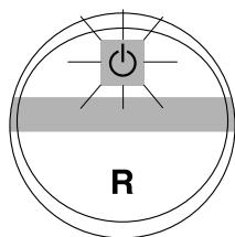
**RUS** Останавливается автоматически при превышении количества уничтожаемой бумаги. Реверс включается автоматически, если произошел затор бумаги.
