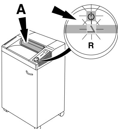
**RUS** Аппарат автоматически остановится, если шторка безопасности (**A**) открыта (индикаторы и будут загораться поочередно). Закройте шторку безопасности и нажмите кнопку - аппарат продолжит уничтожать бумагу. Машина может работать некоторое время в реверсном направлении с открытой шторкой безопасности, если Вам необходимо удалить обрезки бумаги или произошло её замятие. Нажмите кнопку "R" несколько раз, если это необходимо.
